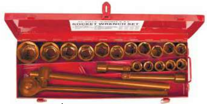
Исп.2 Искробезопасное — омеднение, толщина покрытия 30–50 мкм.
