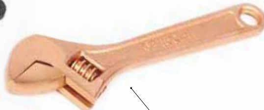
Исп.2 покрытие искробезопасное — омеднение, толщина покрытия 30–50 мкм
